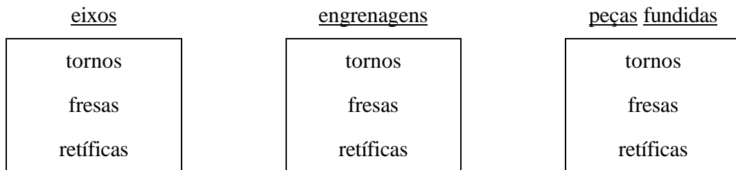
Figura 3.2 - Disposição de Máquinas por Tipo de Peça, Empresa A
